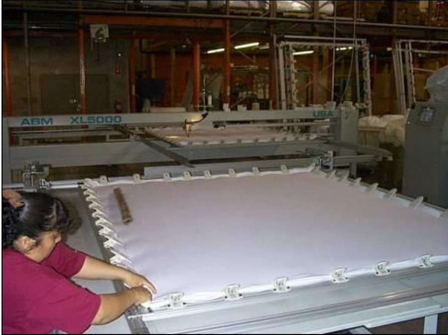
Resim1.37: Kumaşın (kumaş, tela, elyaf, tela ve kumaş) kasnağa yerleştirilerek mandallarla tutturulması
