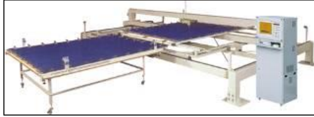
Resim 2.2: Tek kafalı yorgan dikme makinesi
