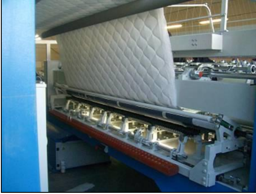
Resim 1.42: Çok iğneli kapitone dikme (yorgan) makinesi
