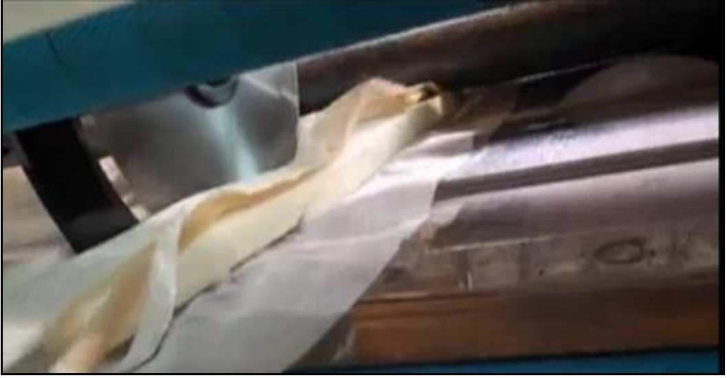
Resim 2.6: Kenar bordüründe belirlenen fazlalıkların otomatik olarak kesilmesi
