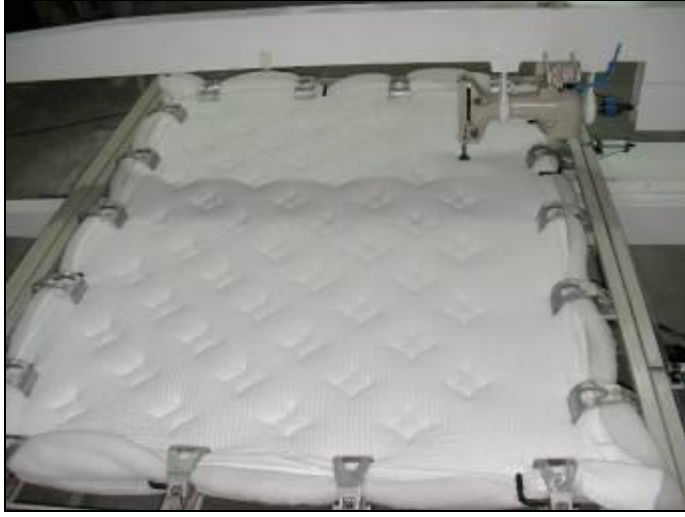
Resim 1.35: Tek kafalı yorgan makinesi (yatak yüzü dikimi)
