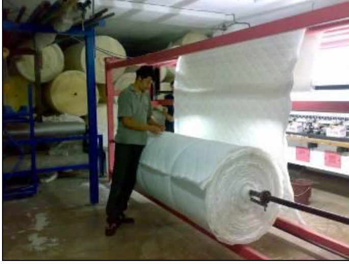
Resim 1.34: Belirli ölçülerde üretilen kapitonenin sarılarak rulo haline getirilmesi
