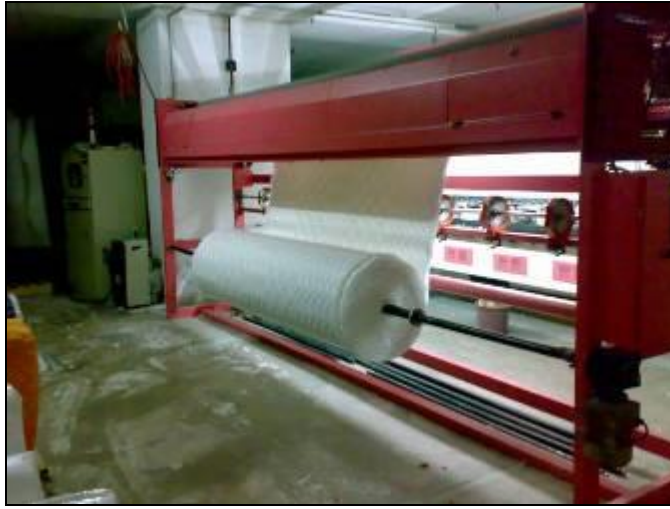
Resim 1.33: Kapitonenin rulo haline getirilerek sarılması
