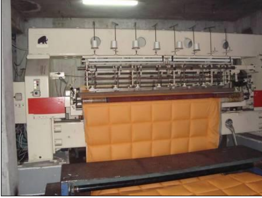
Resim 1.40: Çok iğneli yorgan dikme makinesi
